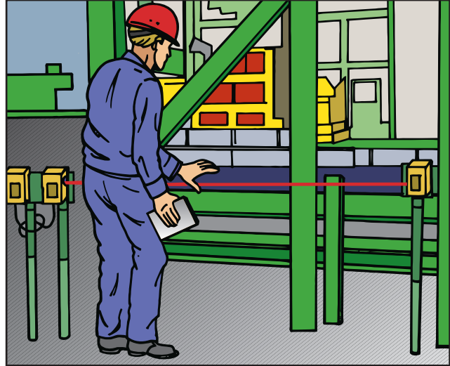
Regelmäßig wiederkehrende Funktionsprüfung der Sicherheitseinrichtungen
