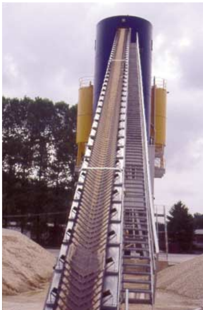
Abb. 23: Treppenaufgang neben einem Steilband
