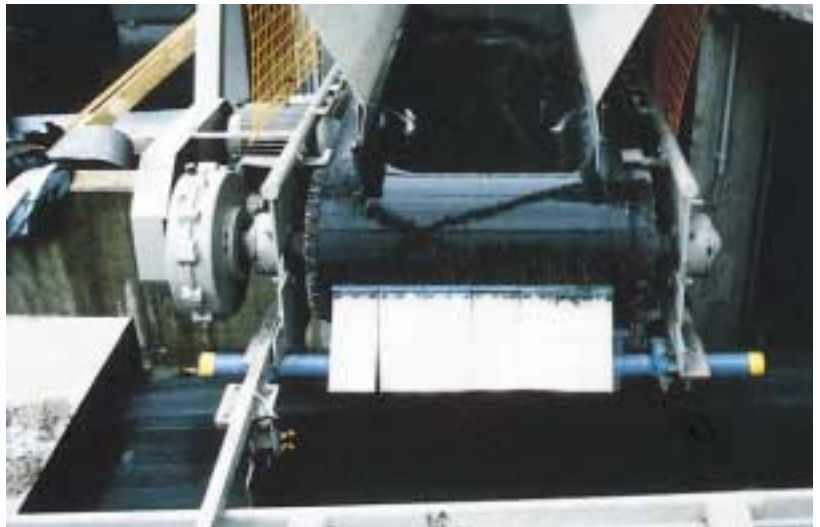
Abb. 24: Federbelasteter Lamellenabstreifer an einer Abwurfstelle
