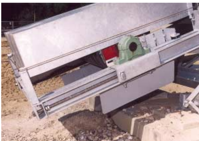
Abb. 7: Verdeckung der Spanntrommel mit Verstellmöglichkeit von außen
