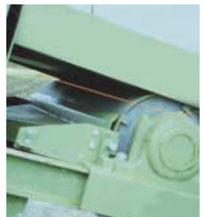
Abb. 9: Pflugabstreifer – zur Sicherheit und Reinigung
