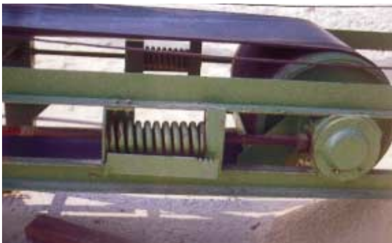
Abb. 8: Winkel als Füllstück an der Spanntrommel
