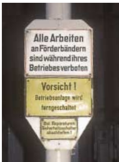
Abb. 45: Hinweisschild an ferngesteuerter Bandanlage
